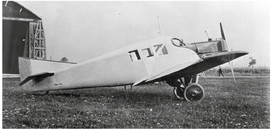
Abb. 17, die Junkers F 13ci/fe, A-38, noch mit der ersten Ausführung des Seitenleitwerks und dem Auspuff oberhalb des Motors. (Archiv ILF-Nachlass Prigl)
